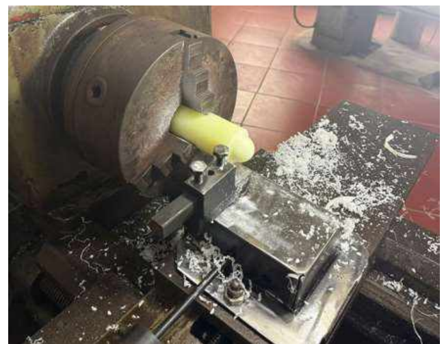
Hình 6. Gia công chi tiết cầu lồi trên máy tiện
