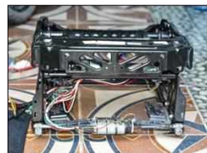
Hình 6. Hộp điều khiển ghé hoàn thiện và các vị trí ghé chỉnh điện
