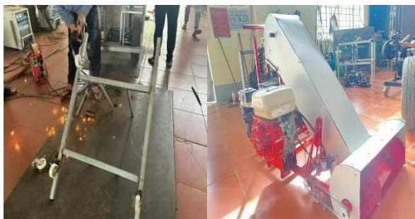
Hình 6. Chế tạo và lắp ghép hoàn thiện máy thu gom nông sản [5]
