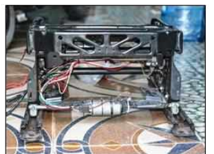
Hình 6. Hộp điều khiển ghé hoàn thiện và các vị trí ghé chỉnh điện
