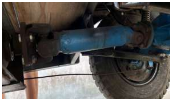
Hình 5. Mô hình hệ thống truyền lực trên xe điện
