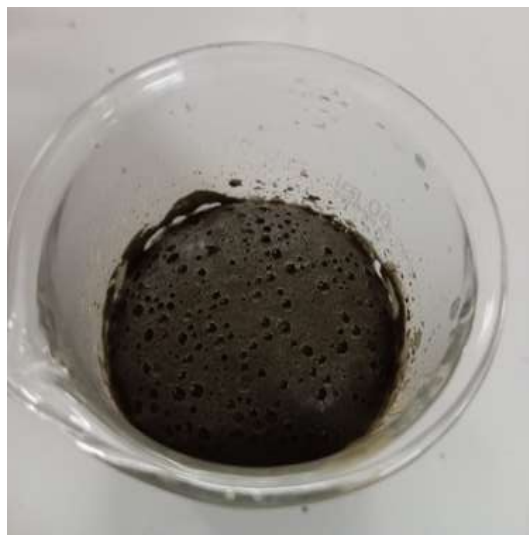
Hình 3. Ảnh bán thành phẩm supe lân kép đảo trộn 5 phút, ủ 5h tỷ lệ H_3PO_4 /Apatite là 23 ml/20g
