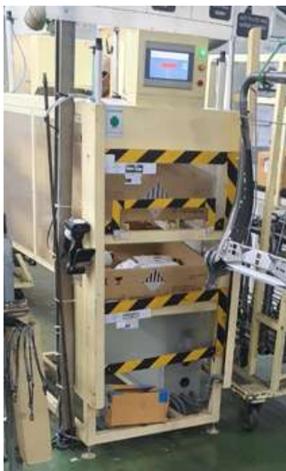
Hình 6. Giá lưu trữ túi khí lắp đặt tại công ty TNHH TOYOTA BOSHOKU HÀ NỘI
