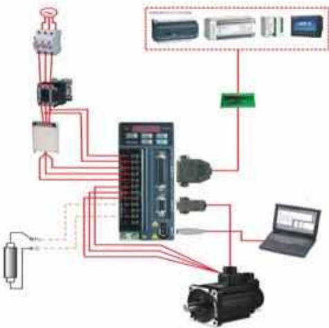
Hình 2: Sơ đồ kết nối Servo Delta ASDA_B2
