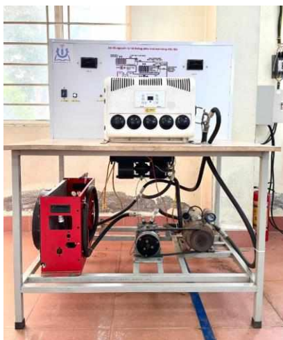
Hình 4: Mô hình hoàn chỉnh hệ thống lạnh hai vùng độc lập trên ô tô
