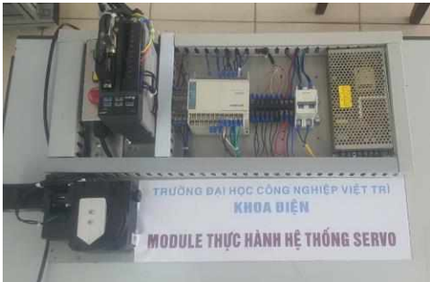
Hình 4: Hệ truyền động servo điều khiển trục xoay
