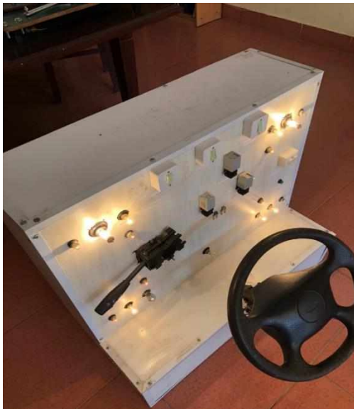
Hình 9: Hình ảnh mô hình hệ thống tự động chiếu sáng và tín hiệu ô tô hoạt động
