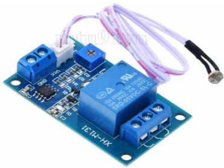
Hình 5: Module cảm biến ánh sáng có relay XH-M31
