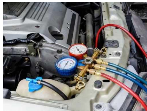
Hình 5: Xác định triệu chứng hư hỏng hệ thống điều hòa trên ô tô
