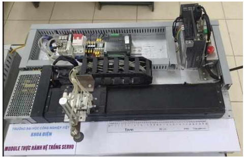
Hình 5: Hệ truyền động servo điều khiển trục vítme Kết quả thử nghiệm
