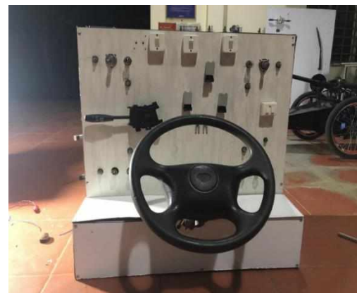
Hình 8: Hình ảnh lắp ráp, hoàn thiện mô hình hệ thống tự động chiếu sáng và tín hiệu ô tô
